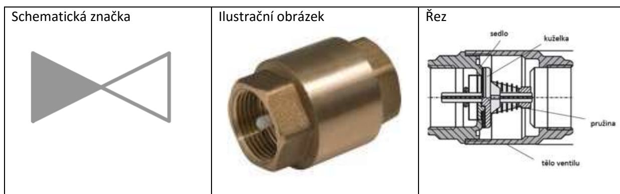
Obr. 17: Zpětný ventil – schematická značka, ilustrační obrázek a řez
